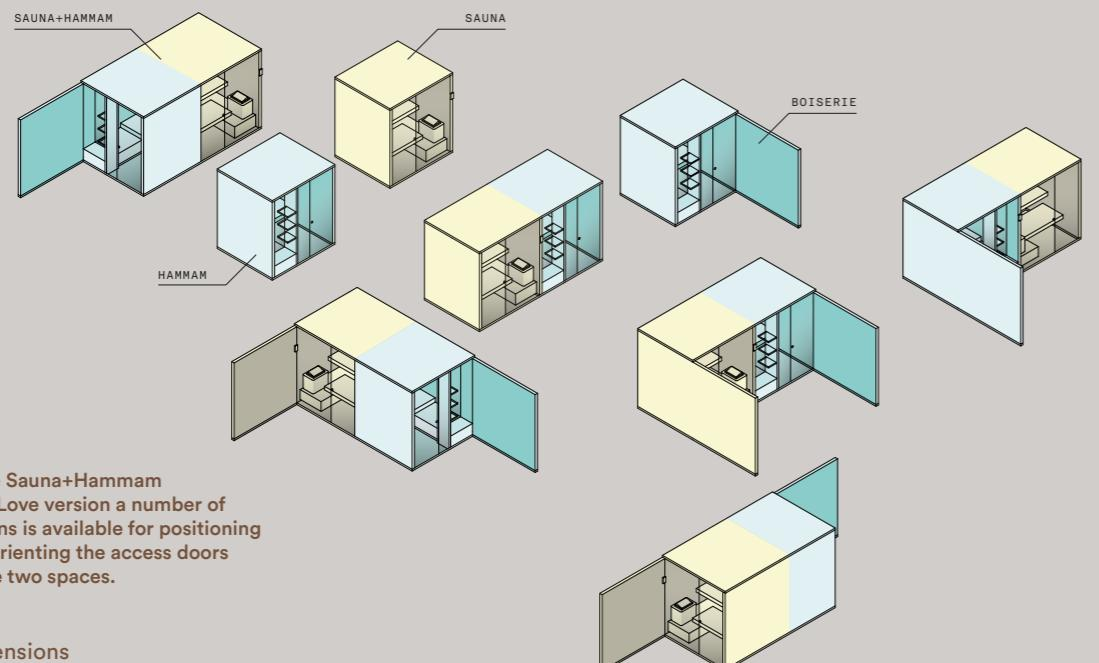
In versione Sauna+Hammam BodyLove permette diverse possibilità di orientamento e posizionamento delle porte di accesso ai due spazi.
